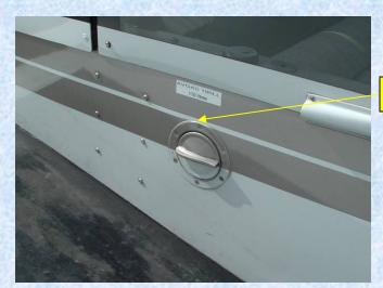
Bouchon de réservoir en place et verrouillé
